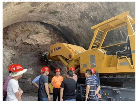
徐工新型掘进机机载超前支护的研制:基于传统型机栽超前支护装置的优缺点,重新设计制造一种新型机載超前支护装置。在继承传统型机载超前支护优点的同时,优化支护装置的结构,使其满足支护强度、长度、高度的要求,优化设计支护装置的液压系统,使之操作灵活、方便。应用ANSYS软件对主要结构件进行有限元强度校核,确保支护装置满足使用要求。
